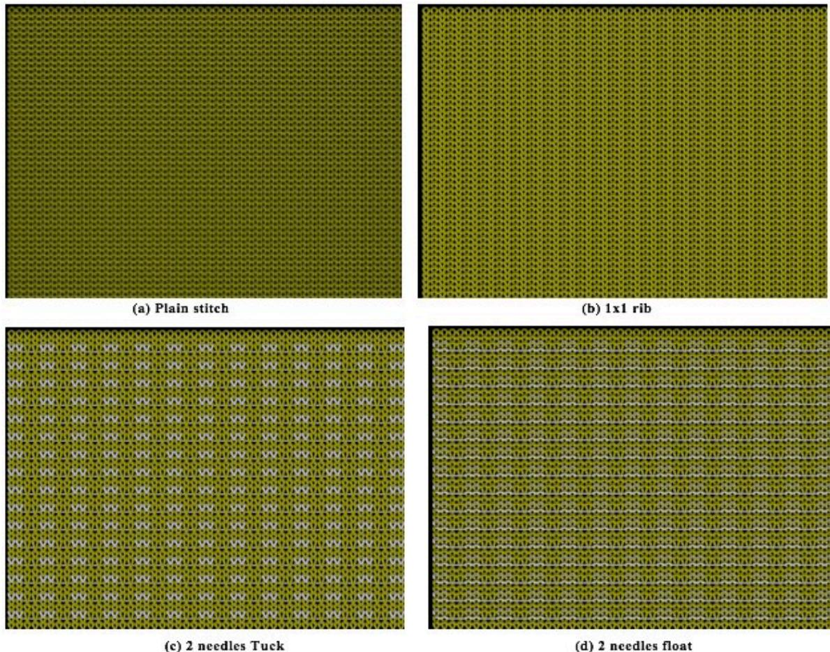
**Figure 4.** Stitch types (a) plain jersey (b) 1x1 rib (c) 2 needles Tuck (d) 2 needles float
